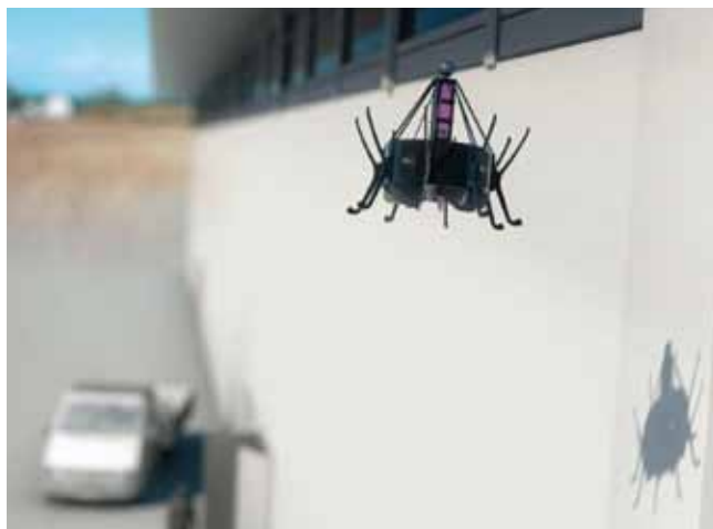
Figuur 2: Voorbeeld van de Airrobot (EU Project), een tele-gestuurde robot.
