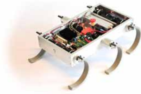
Figuur 1: De autonome zesbenige robot Zebro loopt en rent op zwaar terrein, klimt over obstakels of op trappen.
