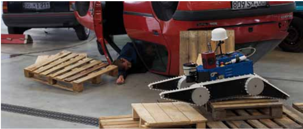
Figuur 4: Reddingsrobot NIFTi vindt een slachtoffer.
